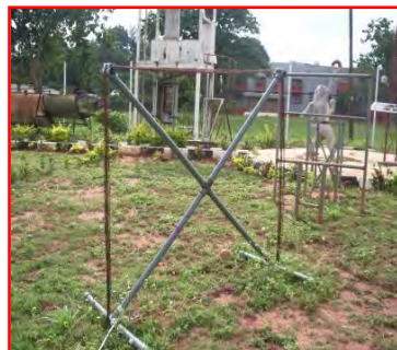
SID monitor VHF loop Antenna.
